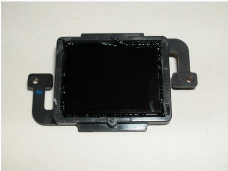
*Il filtro originale e' stato rimosso dalla sua sede naturale ed e' stato sostituito con il filtro IR.*
