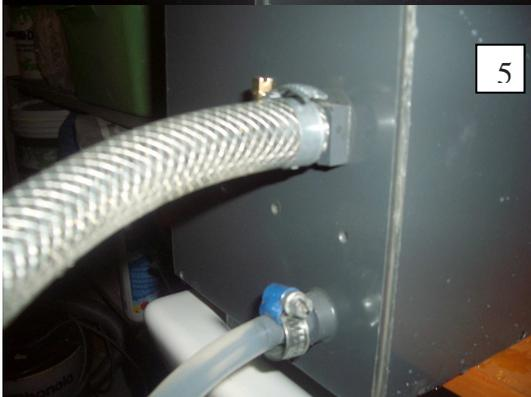
Dettaglio dei bocchettoni di entrata e uscita dell'acqua. Costruiti con il tornio e semplicemente incollati come si può ben vedere. I tubi fissati con due fascette a vite. Ognuno li adatti come diametro esterno, al tubo che possiede.
